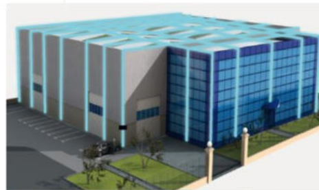
Edificio protegido mediante sistema de malla
